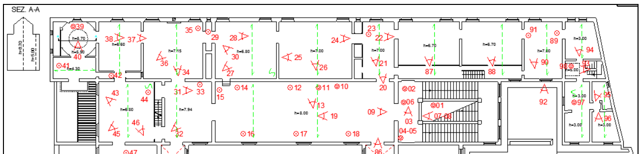
figura 5.8.2c - Corpo settentrionale: Orditura solai di piano secondo
