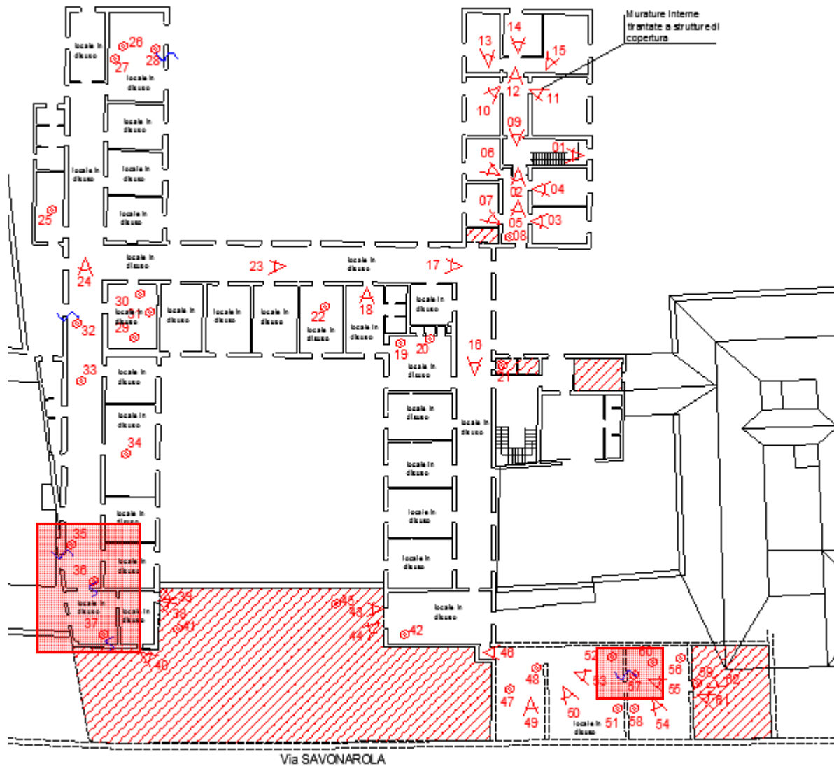
figura 5.5.3 - Pianta piano secondo: indicazione lesioni in strutture verticali
