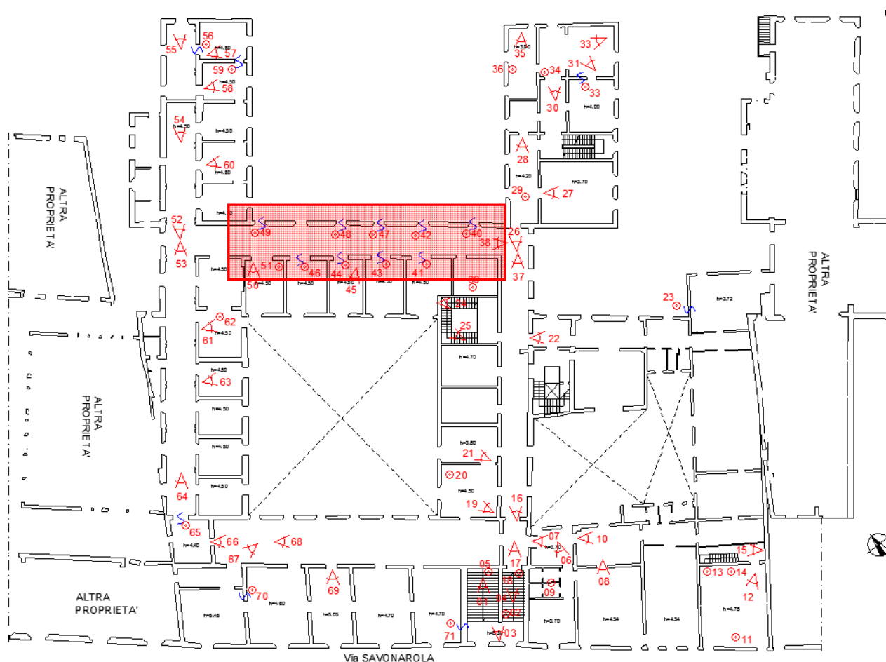
figura 5.5.1 - Pianta piano primo: indicazione lesioni in strutture verticali
