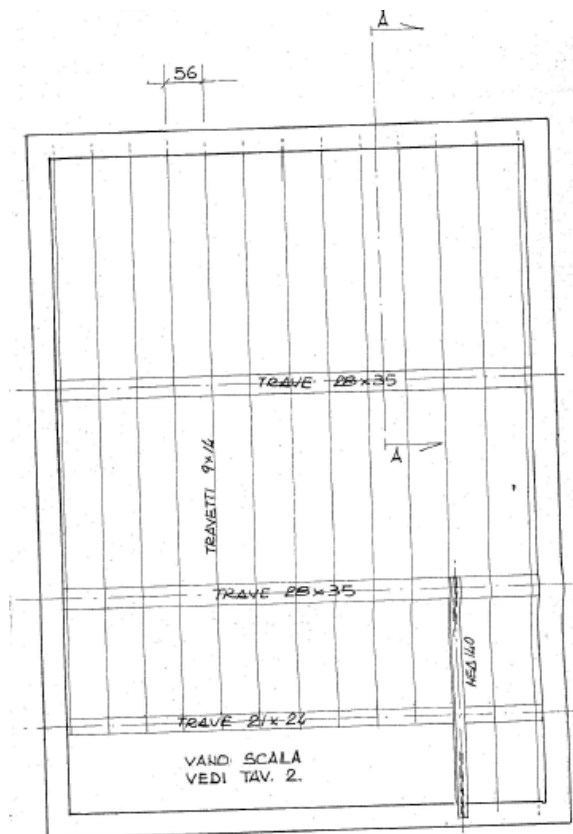
Figura 4.6e - Torre: pianta 4° piano - intervento di consolidamento (Mezzadri, 1970)
