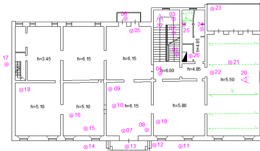
figura 4.4.3a - Planimetria solaio di piano secondo (solai lignei "L", solai in acciaio "A")
